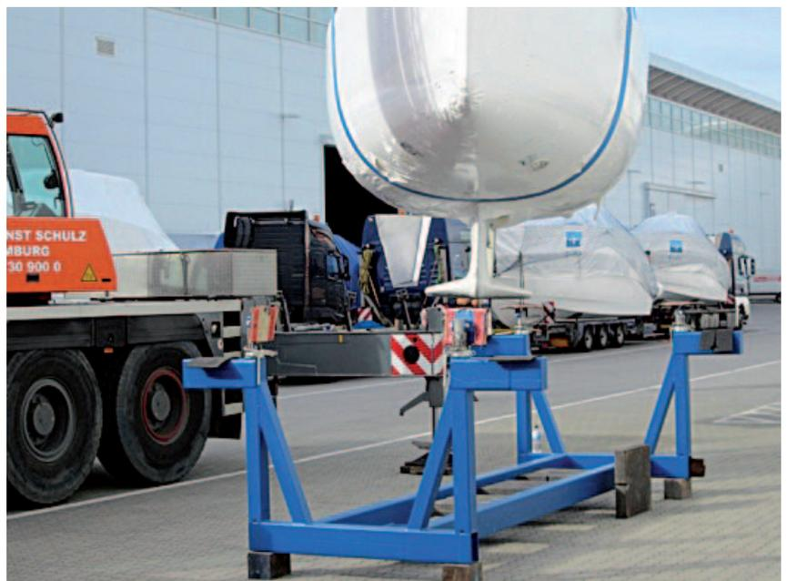
Sleepy kann durch das Hubbocksystem Verladezeit und Kranung sparen. Der Laster kann den Anhänger herunterlassen, schiebt ihn unter das Gestell und pumpt sich mit dem Boot wieder hoch.
