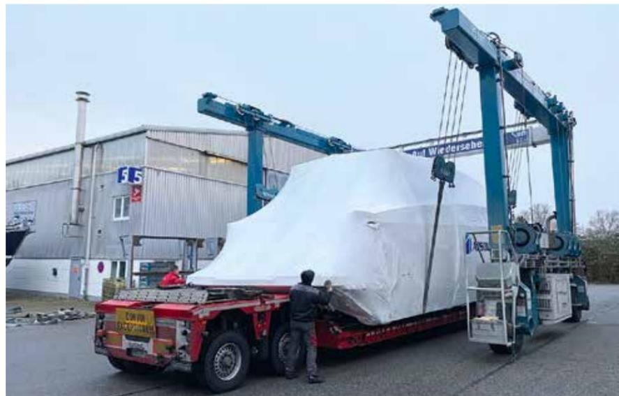
In der norditalienischen Bootswerft Absolute S.p.A. wird die 19 Tonnen schwere Motoryacht auf den zweiachsigen Pendelachsflachbett-Trailer Euro 49 PX des niederländischen Herstellers Nootboom Trailers B.V. verladen.
